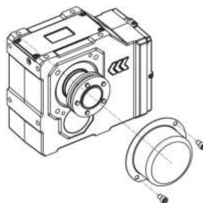
Рис. 10: Защитный кожух стяжной муфты полого вала
