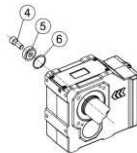
Рис. 6: Установка вала заказчика при помощи крепежного набора WATT с контактным упором
