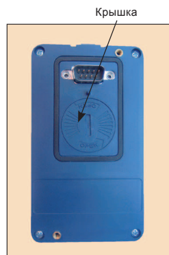
Рис. 28.: Крышка аккумуляторной батареи клавиатуры для доступа к батарее
