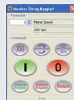
Окно наблюдения и управления с экранной клавиатурой. Функции запуска, останова, толчка, локального и удаленного управления, возврата и сброса.
